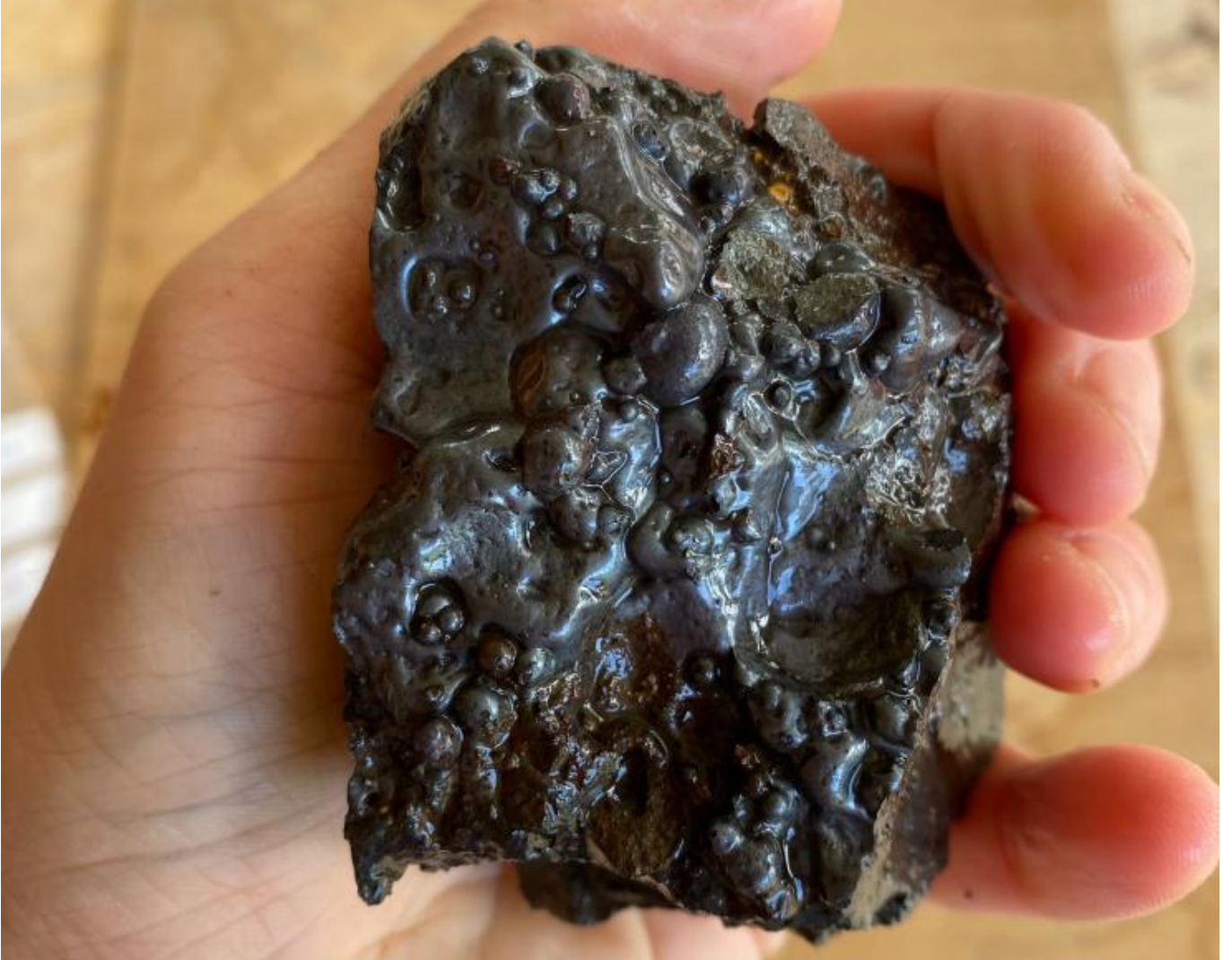
En bit slagg från årets fältarbete som dokumenteras i labbet. Olika typer av slagg kommer från olika delar av den metallurgiska processen och framställningen av järnet. Foto: författaren.
